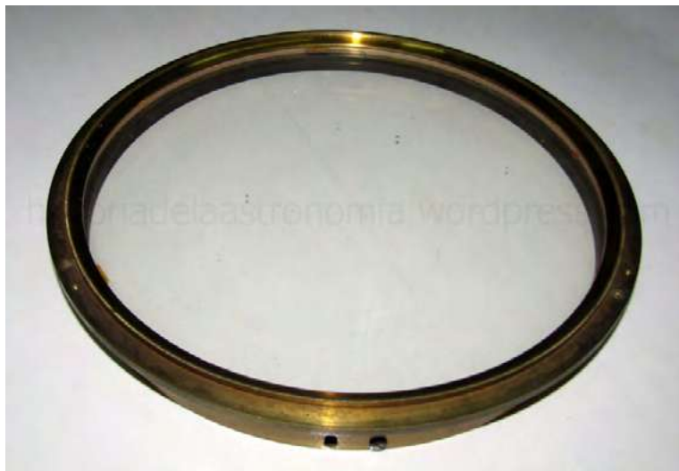
Figura 3. Objetivo con el que se realizaron las Fotografías Cordobesas entre 1872 y 1882, fabricado por Rutherford en 1864 y comprado por el Observatorio Nacional Argentino en 1871. Se trata de una pieza única, de las más valiosas de la colección del Museo del Observatorio Astronómico de Córdoba (Archivo Museo OAC, El Autor).
