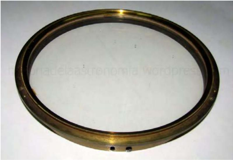
**Figura 3.** Objetivo con el que se realizaron las Fotografías Cordobesas entre 1872 y 1882, fabricado por Rutherford en 1864 y comprado por el Observatorio Nacional Argentino en 1871. Se trata de una pieza única, de las más valiosas de la colección del Museo del Observatorio Astronómico de Córdoba (Archivo Museo OAC, El Autor).
