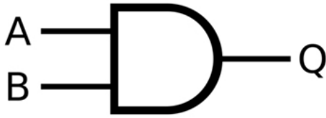
Fig. 1: Ejemplo de puerta AND de dos entradas y una salida, donde A es un voltaje bajo entre 0.1 V y 0.5 V, y B es un voltaje alto entre 1.1 V y 1.5 V.
